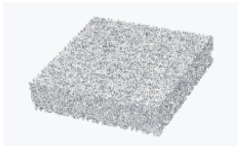
图 12 泡沫铝三维物质点法模型
