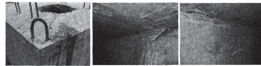
(a) 主爆室顶板与侧墙的破坏情况(实验)
